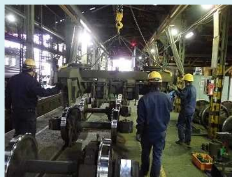
【台車組み立て作業】
